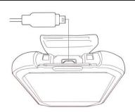
**Verbindung USB Kabel mit Kamera**
