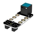
Linienfolgesensor: misst helle und dunkle Übergänge am Boden und folgt ihnen.
